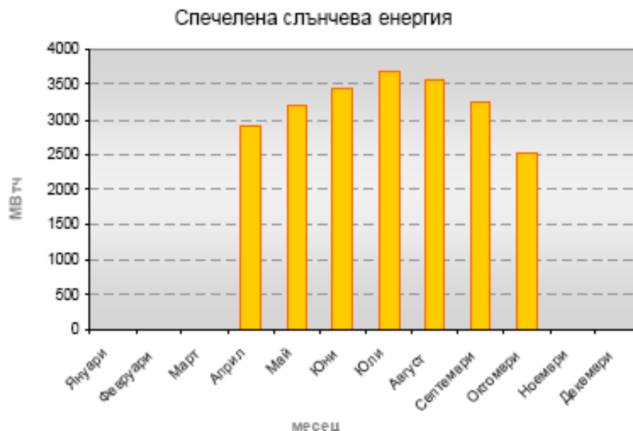
Фиг. 17: Разпределение на възможната за оползотворяване слънчева енергия по месеци при сезонна работа на инсталациите
